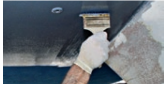
Overstryg Hempel's High Protect i modsat retning med pensel
