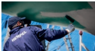
Påfør bundmaling oven på primer eller hæfteprimer
