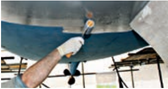
Påfør Hempel's High Protect II med rulle
