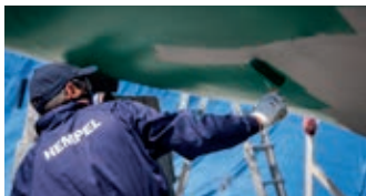
Påfør bundmaling oven på primer eller hæfteprimer
